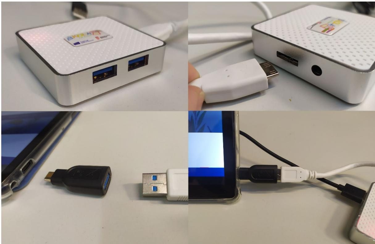
Primjer ispravnog načina spajanja USB huba sa adapterom sa konektora Type C na Type A.
